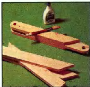
Все детали рам склеены из досок 60x20 мм так, чтобы они имели на концах шипы или пазы.
