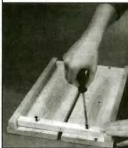
Размечаем на стойках положение брусков, приворачиваем их к доскам.
