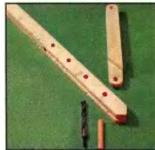
В диагональных деталях рам сверлят по четыре отверстия для штырей.
