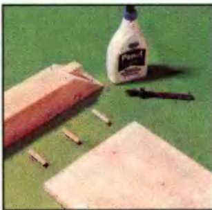
Тыльную доску соединяют со стойками рам на шкантах с клею (по три с каждой стороны).
